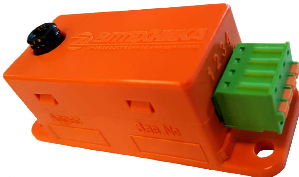
Рис. 1 Внешний вид пирометрического датчика температуры «Контроль-Т».
